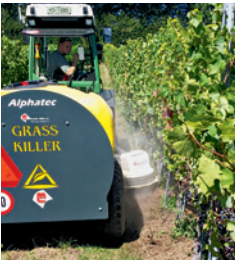
De l'eau est giclée sur la plante au travers de petites buses et à haute pression, afin de la détruire et de la mélanger ensuite à la terre.
